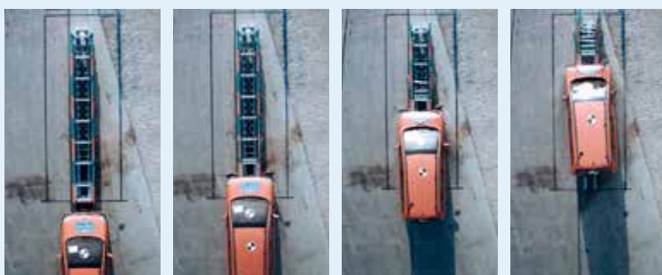
Crash test: Il veicolo si ferma in modo controllato e sicuro.
